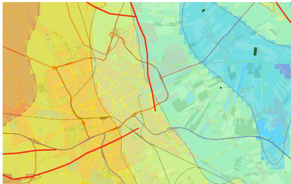
Figuur 3 - Temperatuur aan de top van de Slochteren Zandsteen in de ondergrond van Groningen. Contourinterval bedraagt 5 graden C. De temperatuur onder de beoogde uitbreiding Meerstad bedraagt 100 tot 105 graden en neemt in westelijke richting toe tot meer dan 120 graden in het westelijke deel van de kaart.
